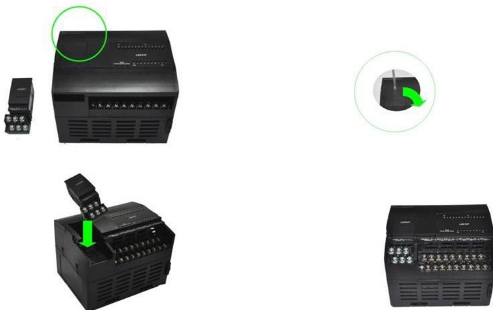
Рисунок 168 Установка платы расширения
